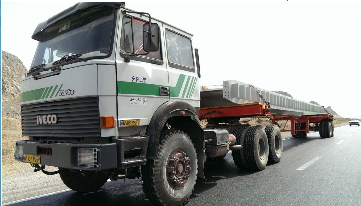
پل فلزی اصفهان حمل تیرهای فلزی پل باطول نوزده متر از کارخانه ساخت شرکت دقیق بوسیله تریلی مخصوص
